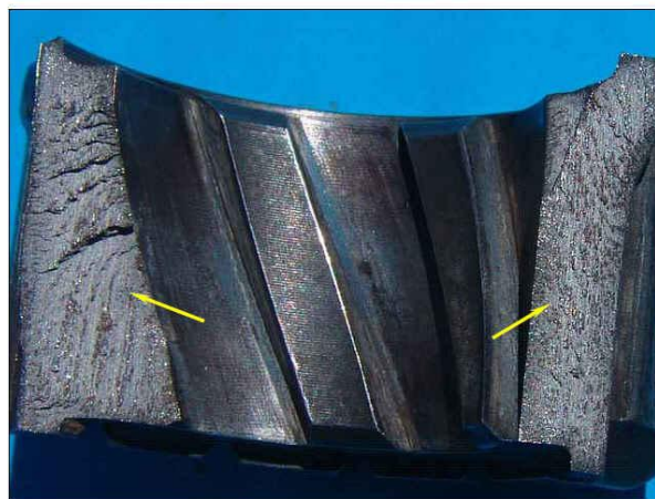
Foto 3. Superficies de fractura súbita frágil del piñón.
