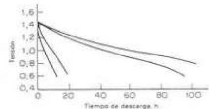
Fig. 7-62. Curvas de descarga de una pila alcalina- MnO_2 .
