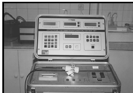
Puente de medida de tangente de delta y capacidad [Tettex]
